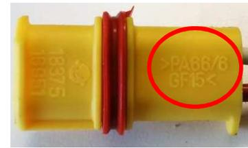
Différents matériaux à faible teneur en fibres de verre (GF) peuvent causer une plus faible durabilité
