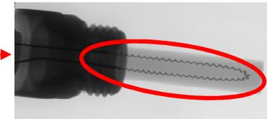
CT montre l'utilisation d'un filament incandescent mécanique (JE utilise la céramique high-tech sans le filament)?
