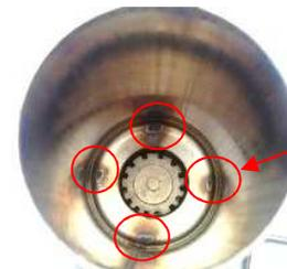
Le tube est soudé par points à l'intérieur
