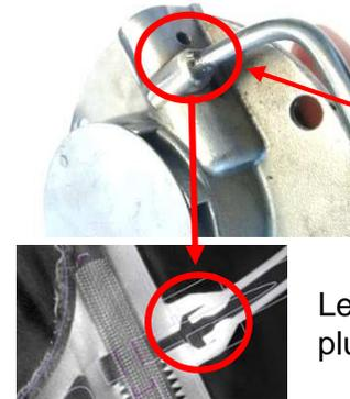
Le tuyau de carburant est mal soudé
