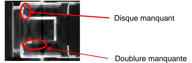
Les caractéristiques manquantes peuvent entraîner un bruit accru et un processus de combustion instable. On peut s'attendre à une augmentation de la fumée et à une durabilité réduite.
